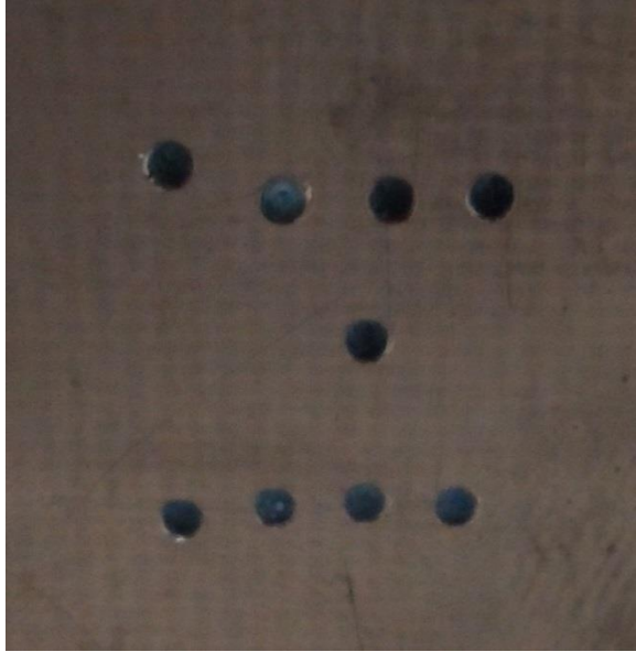
Figura 36 - Resultado dos furos utilizando a fresadora CNC
