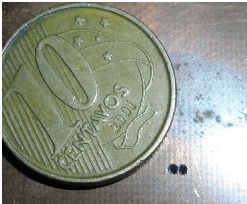
Figura 30 - Furos realizados com uma broca de 1mm, com uma distancia entre furos de 1mm.
