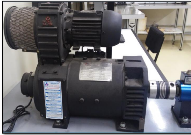
Figura 8 - Máquina de Corrente Contínua da bancada.
