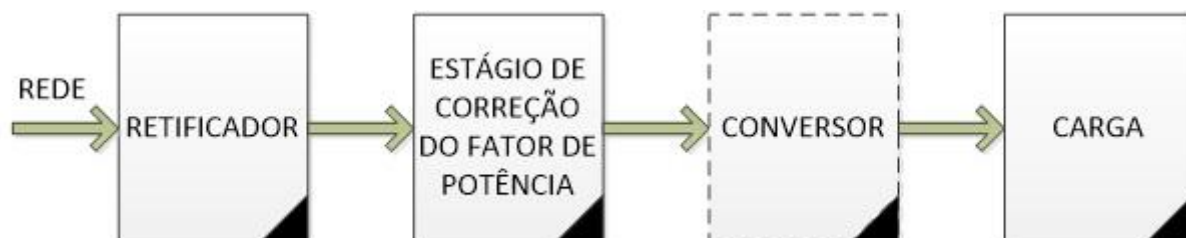
Figura 15 - Diagrama simplificado dos estágios de correção do fator de potência
