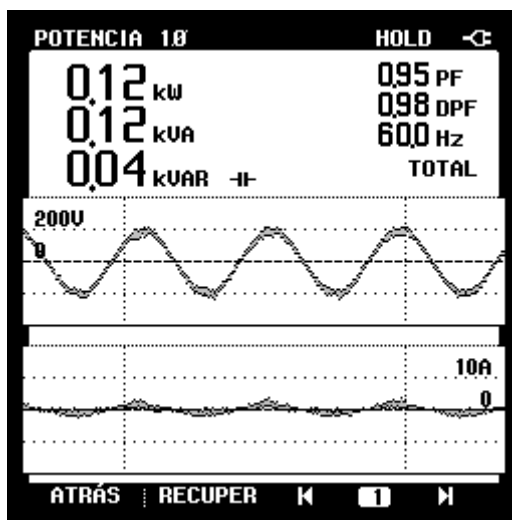
Figura 47 - Fator de potência, fator de deslocamento e potências para 120W de carga
