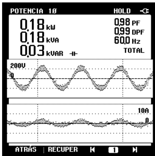
Figura 52 - Fator de potência, fator de deslocamento e potências para 189W de carga
