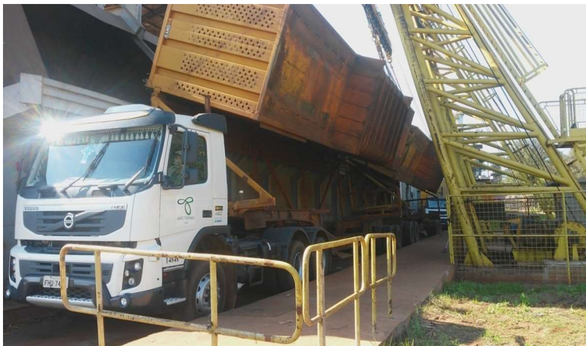
Figura 4: Guincho suspendendo as carretas de cana-de-açúcar. Fonte: Próprio autor.
