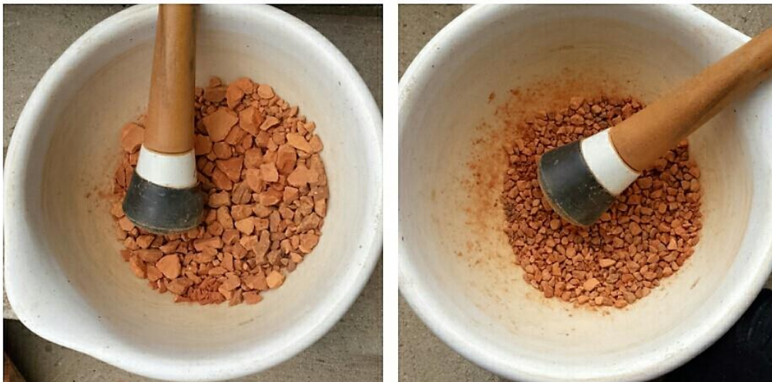
Figura 7 - Maceração da cerâmica para obtenção da granulometria desejada. Fonte: Autoria própria, 2016.
