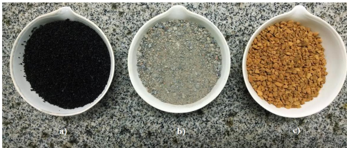
Figura 10 – Materiais adsorventes analisados. a) Carvão ativado granular; b) Resíduos da construção civil reciclados; c) Cerâmica. Fonte: Autoria própria, 2016.
