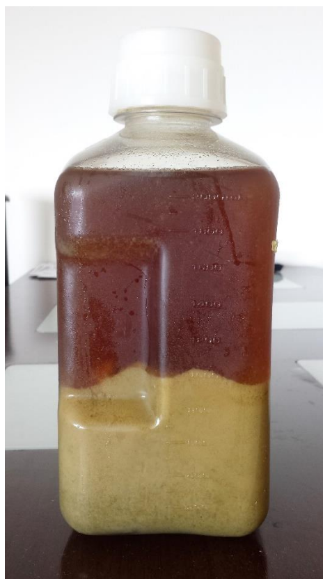
Figura 5 - Efluente depois de 24h de repouso para decantação de sólidos. Fonte: Autoria própria, 2016.
