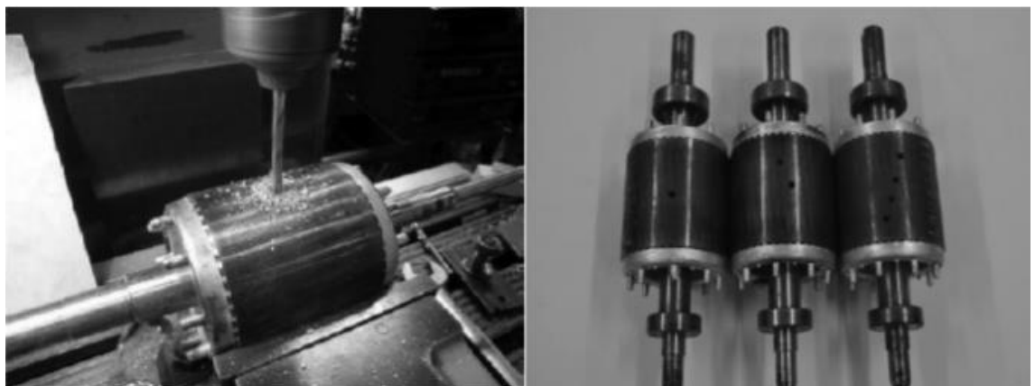
Figura 10: Rotor com quebra forçada das barras.
