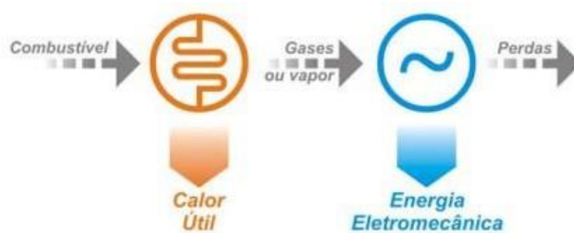
Figura 6 – Cogeração tipo Bottoming.
