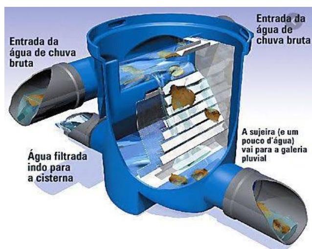
Figura 10 - Funcionamento do dispositivo autolimpante
