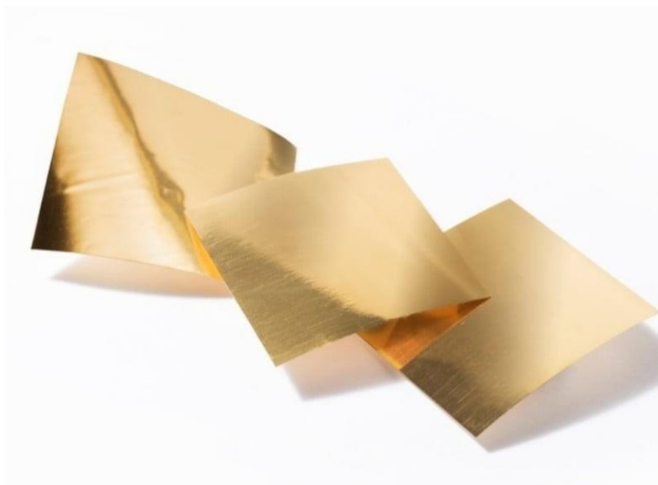
Figura 16 – Filme PVDF (Fluoreto de Polivinilideno) utilizado como elemento sensor.
