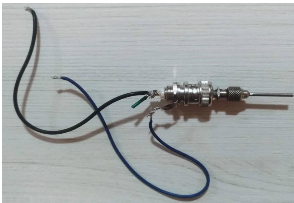
Figura 14 – Hidrofone tipo agulha construído.
