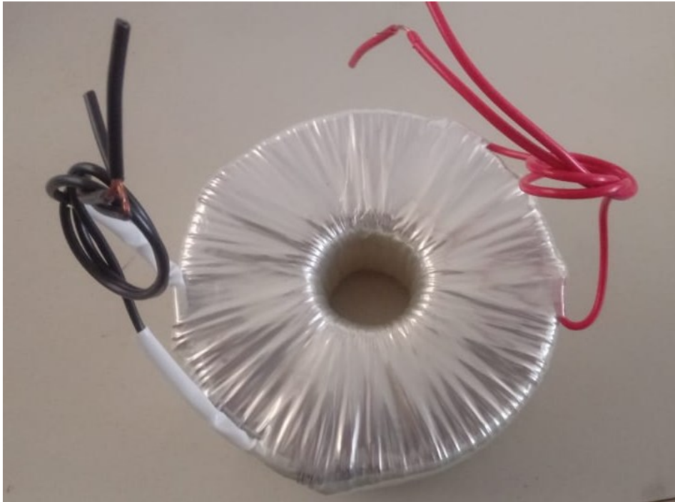
Figura 15: Transformador finalizado. Fonte: autoria própria.
