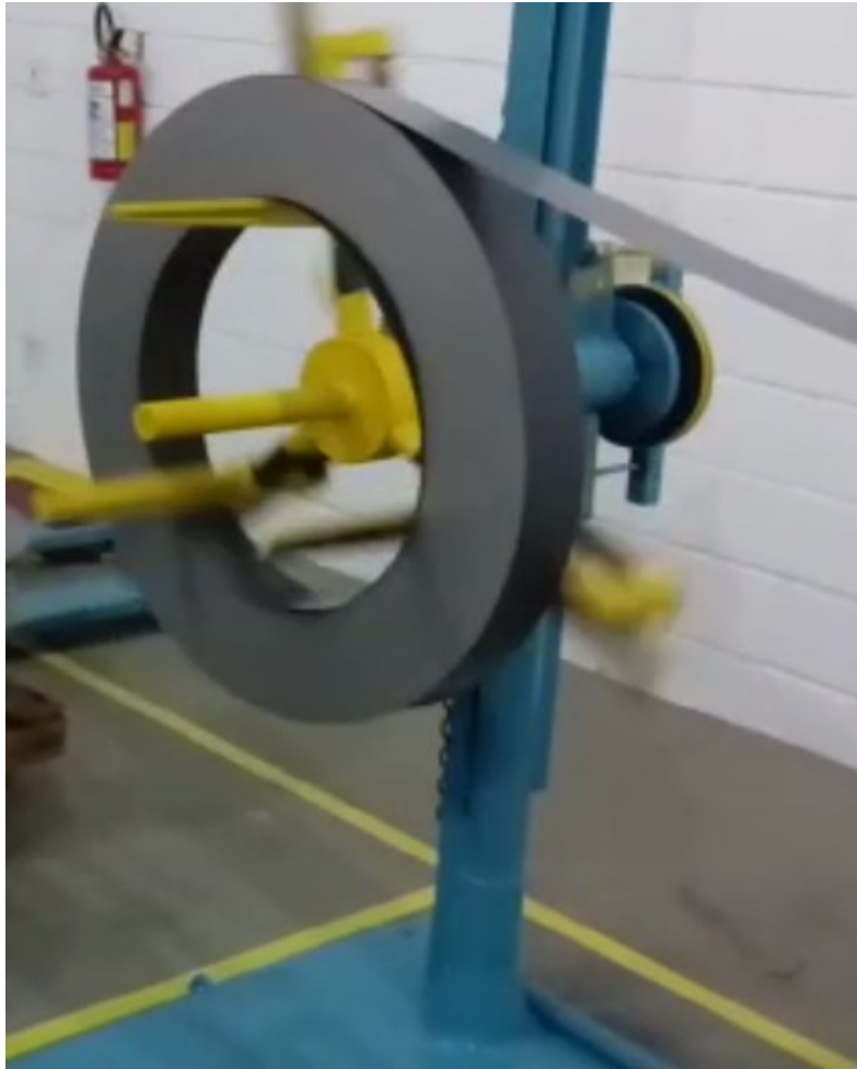
Figura 6: Matéria prima já posicionada na máquina responsável pela fabricação do núcleo. Fonte: LTC Transformadores.
