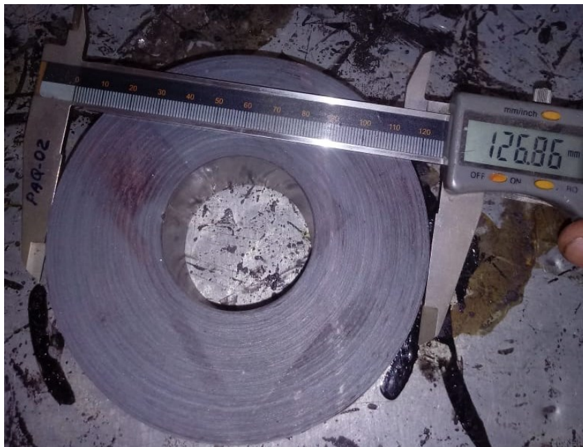
Figura 9: Dimensão O_d (diâmetro externo) do núcleo após finalizada a construção. Fonte: LTC Transformadores.
