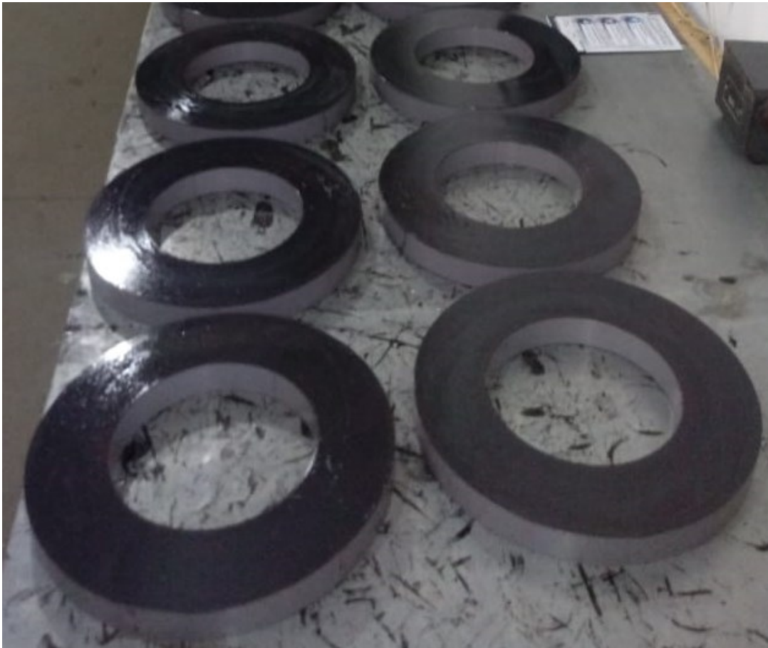
Figura 12: Processo de aplicação de verniz no núcleo (imagem ilustrativa). Fonte: LTC Transformadores.
