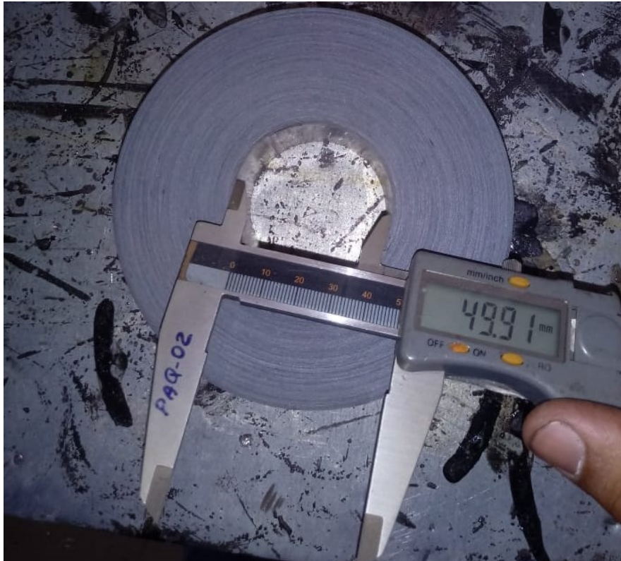
Figura 10: Dimensão I_d (diâmetro interno) do núcleo após finalizada a construção. Fonte: LTC Transformadores.
