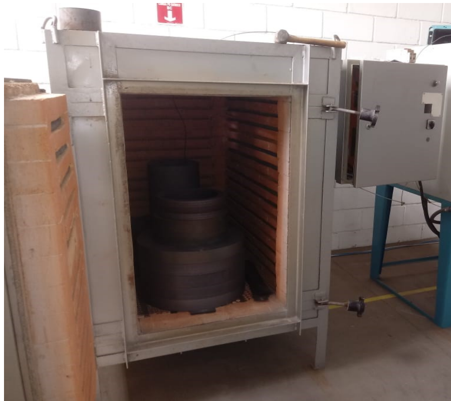
Figura 11: Forno utilizado para o aquecimento do núcleo. Fonte: LTC Transformadores.
