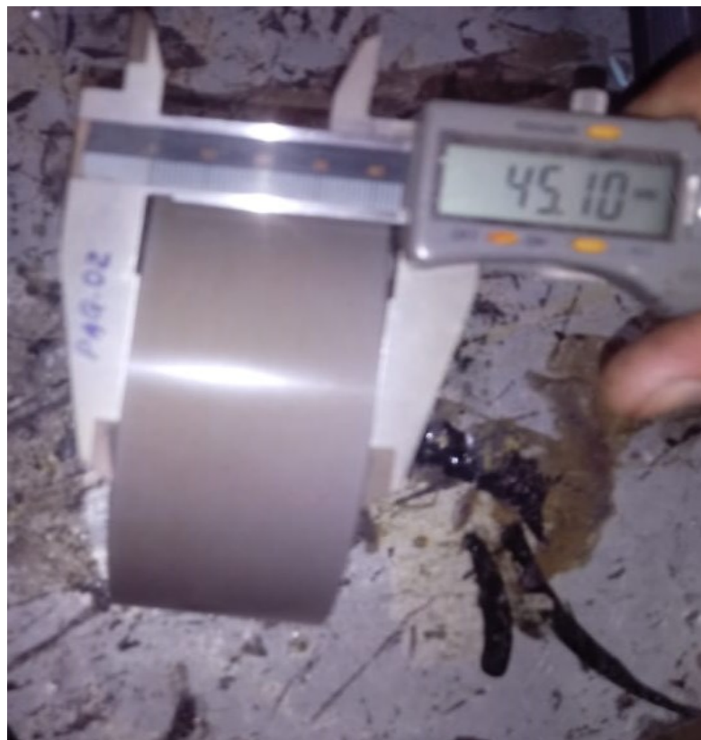
Figura 8: Dimensão H_t (altura) do núcleo após finalizada a construção. Fonte: LTC Transformadores.
