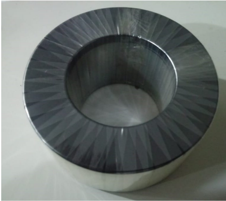
Figura 13: Núcleo finalizado já com a aplicação do acabamento em pu (poliuretano). Fonte: LTC transformadores.
