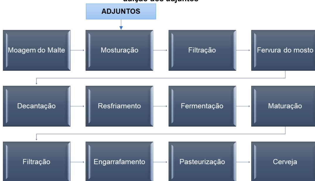
Figura 6 – Fluxograma das etapas de processamento da cerveja com destaque para a de adição dos adjuntos
