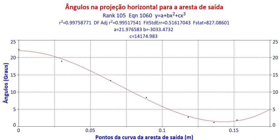
Figura 22 - Ângulos na projeção horizontal para a aresta de saída.
