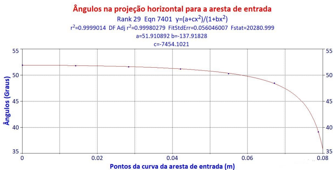
Figura 19 - Ângulos na projeção horizontal, para a aresta de entrada.
