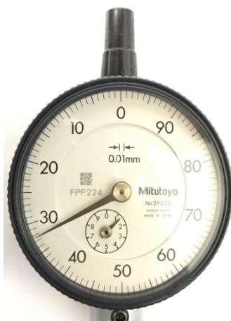
Figura 80: Instrumento de medição relógio comparador centesimal
