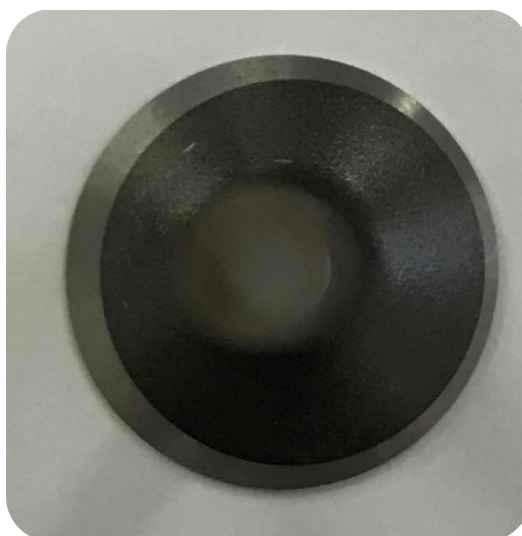
Figura 60: Vista superior da válvula V-5991 com o defeito 'excentricidade da sede'
