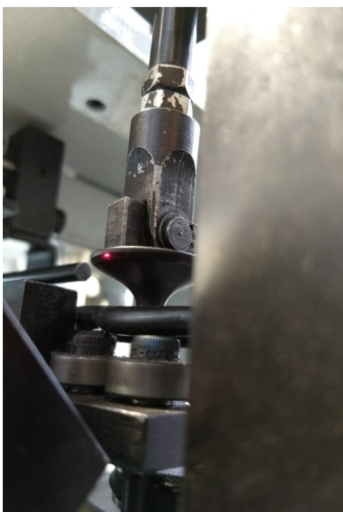
Figura 33: Posicionamento do laser na sede da válvula.
