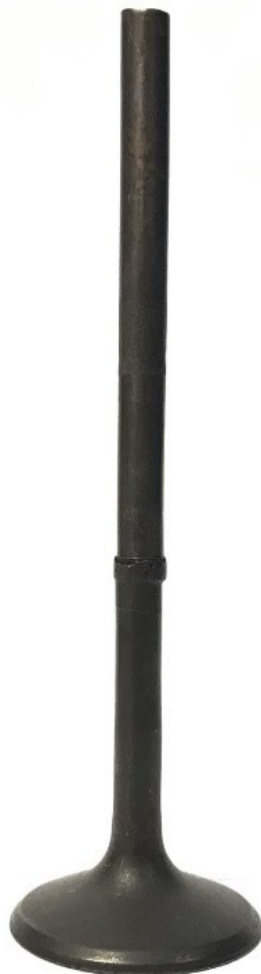
Figura 30: Visual da válvula após endireitamento
