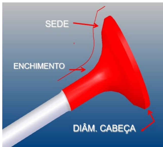
Figura 48: Características usinadas na HSG
