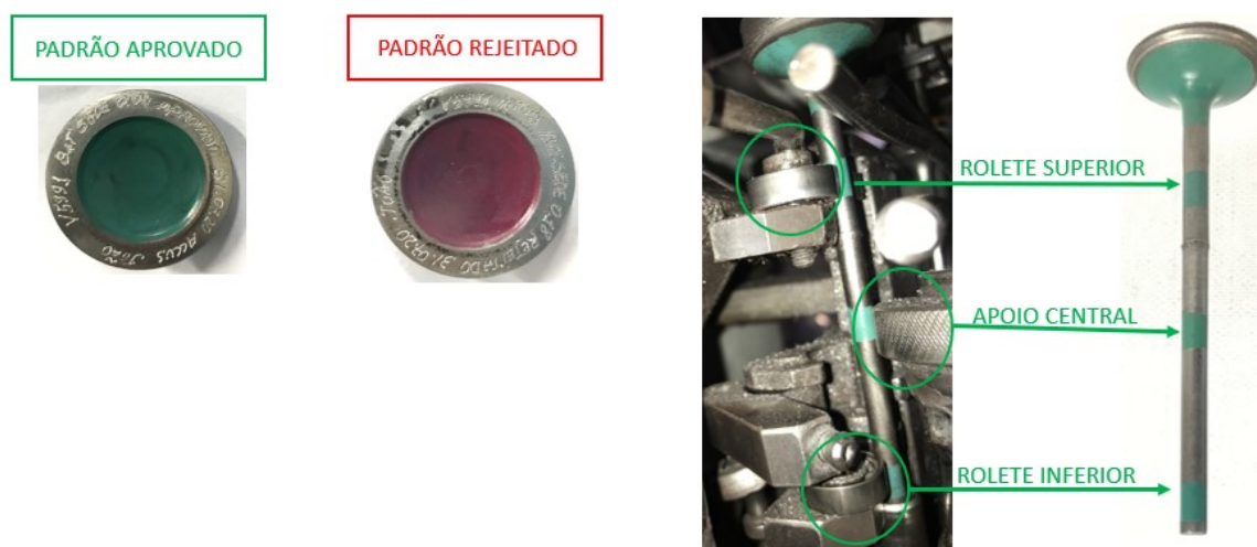
Figura 126: Padrões e auxílio visual para setup da máquina
