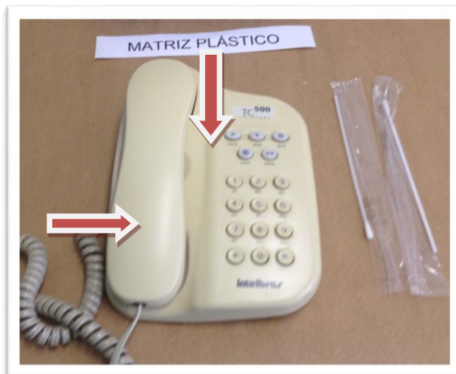
Figura 21 - Matriz plástico: impressão digital intacta e esfregão sem pó
