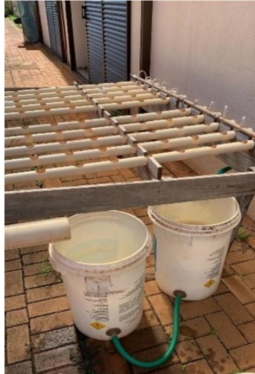
Figura 8 - Construção dos Reservatórios Hidropônico.
