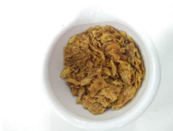
Figura 7 – Amostra seca, triturada em graal e pistilo, para quantificação de Lipídios por Soxhlet.
