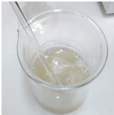
Figura 6 – Diluição da amostra para a quantificação de açúcares redutores por DNS.
