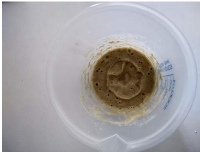
Figura 5 – Amostra homogeneizada em mixer para a quantificação de açúcares redutores por DNS.
