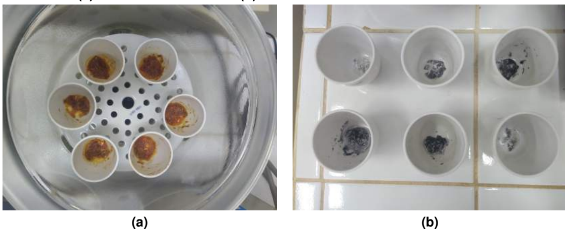
Figura 9 – Análise de sólidos totais. Amostras no dessecador após secagem em estufa (a) e amostras em cinzas (b).
