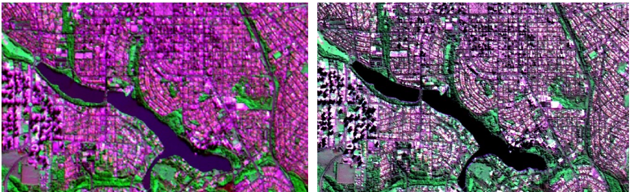
Figura 2 – Imagem em composição colorida de 8 m de resolução(esquerda) e depois da fusão entre as bandas, com resolução de 2 m (direita).
