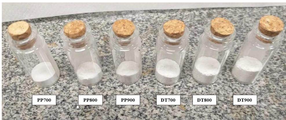
**Figura 16.** Nanopartículas de  $\text{Nb}_2\text{O}_5$  obtidas após calcinação.
