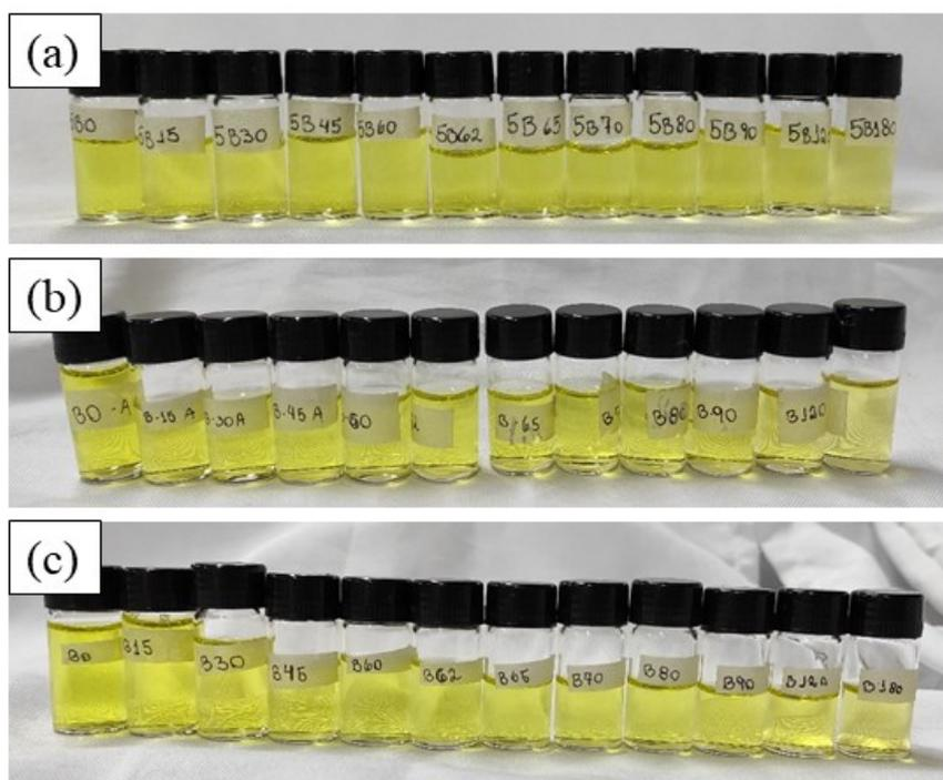
**Figura 36.** Alteração temporal da coloração da solução de corante amarelo reativo BF-4G durante os testes fotocatalíticos conduzidos com fotocatalisador DT700, 25 mg L<sup>-1</sup> de corante em pH = 3. Concentrações de fotocatalisador empregadas: (a) 0,5, (b) 1,0, (c) 2,0 mg L<sup>-1</sup>.
