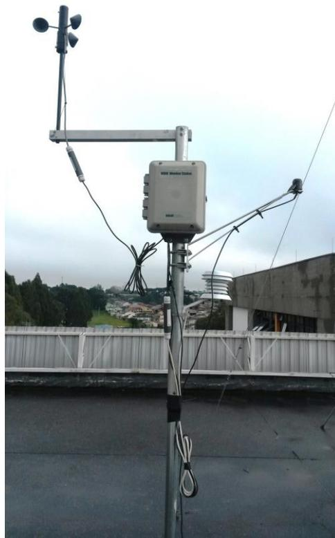
**Figura 13 – Estação meteorológica externa - referencial**
