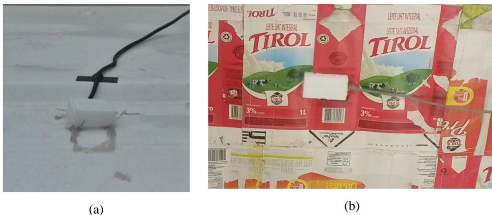
**Figura 25 – Em (a) sensor isolado por isopor e fixado na cobertura da guarita controle para medição da temperatura superficial externa e (b) sensor isolado por isopor e fixado na manta Tetra Pak® voltada para a cobertura para medição da temperatura superficial interna**
