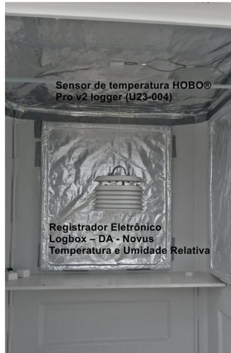
**Figura 15 – Posição dos sensores no interior da guarita experimental**
