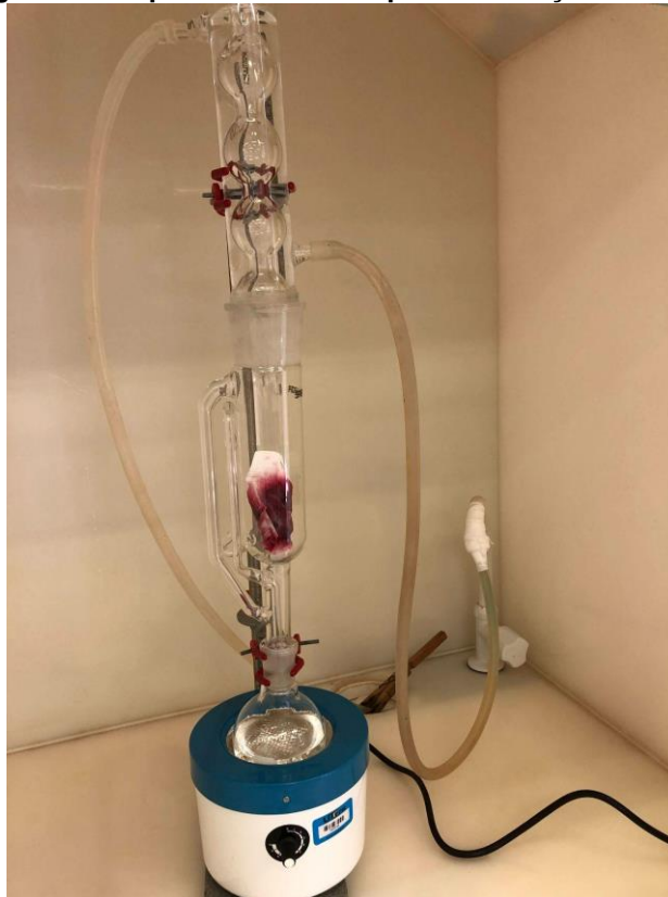
Fotografia 5 – Aparelho utilizado para a extração de Soxhlet
