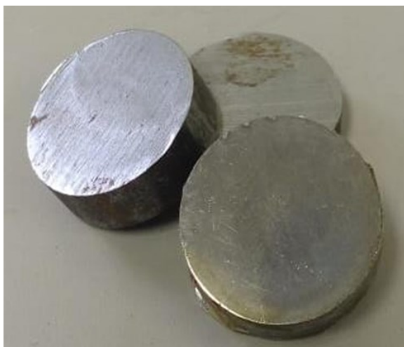
Figura 4 - Amostra cortada para ser embutida.
