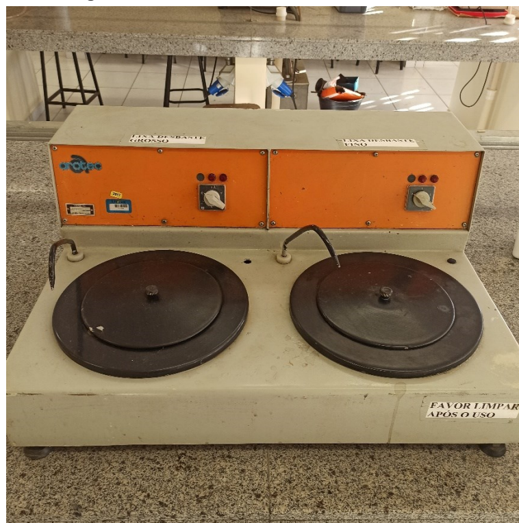
Figura 6 - Lixadeira utilizada, modelo APL 4D.
