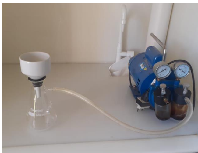
Fotografia 2 - Esquema de filtração das amostras.
