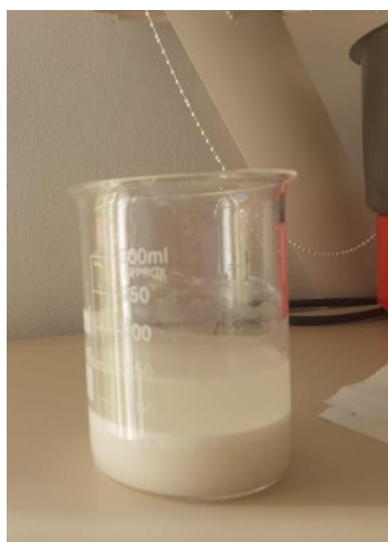
Fotografia 1 - Amostra de sílica gel sob tratamento com peróxido de hidrogênio.
