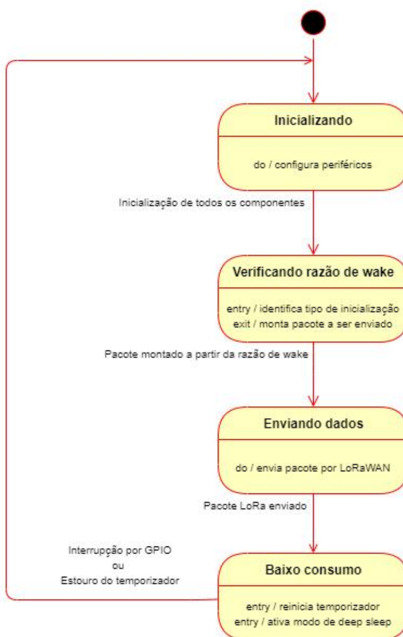
Figura 18 – Diagrama de estados do sistema do nó transmissor.
