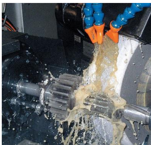
Figura 8 - Teste com fluido de corte de origem vegetal (óleo de mamona)
