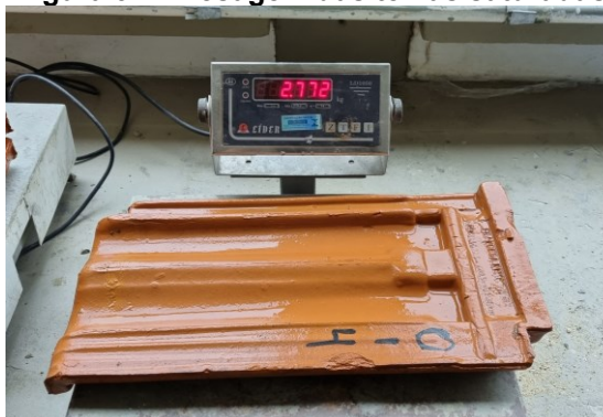
Figura 31 – Pesagem das telhas saturadas
