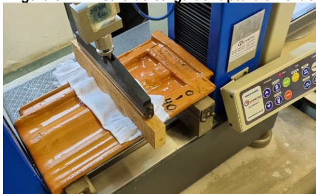
Figura 32 – Ensaio de carga de ruptura à flexão
