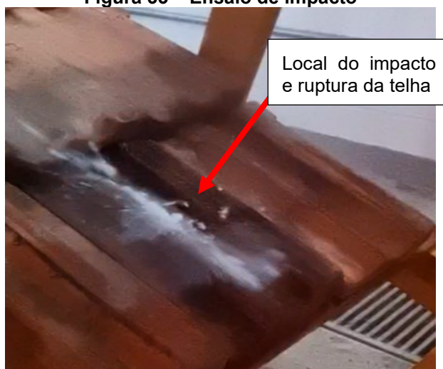
Figura 33 – Ensaio de impacto
