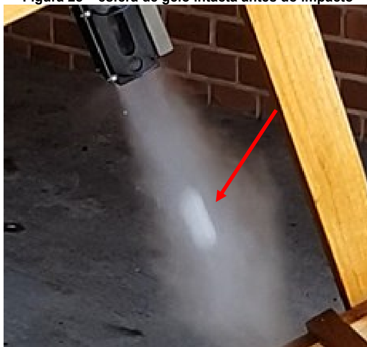
Figura 28 – esfera de gelo intacta antes do impacto
