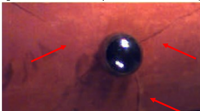
Figura 20 – Momento do impacto de uma esfera de aço
