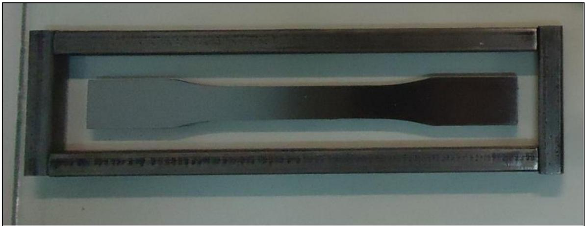
**Figura 14 - Estrutura para fabricação do molde de silicone**
