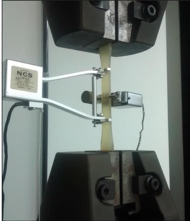
**Figura 18 - Posicionamento do CDP de tração na máquina de ensaios**
