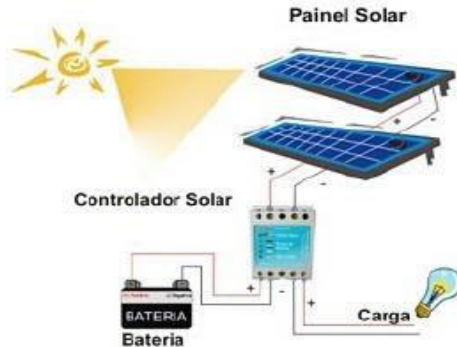
Figura 2.7 – Painel fotovoltaico alimentando um controlador Fonte: windpowerbrasil.blogspot.com .
