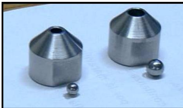
Figura 19 - Pinos tipo esfera com seus respectivos porta-pinos Fonte: Adaptado de RIVEROS (2006).
