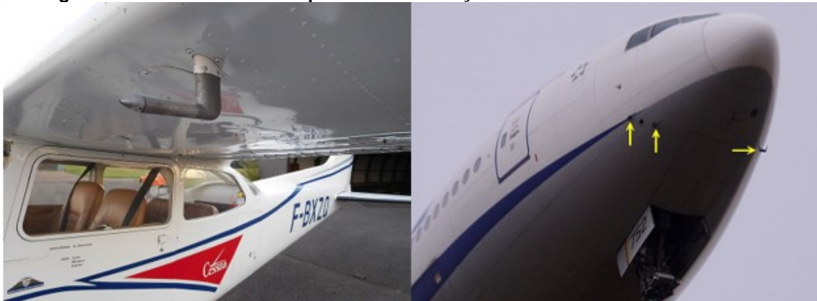
Figura 13: Vista de diferentes pontos de instalação do tubo de Pitot em aeronaves.
