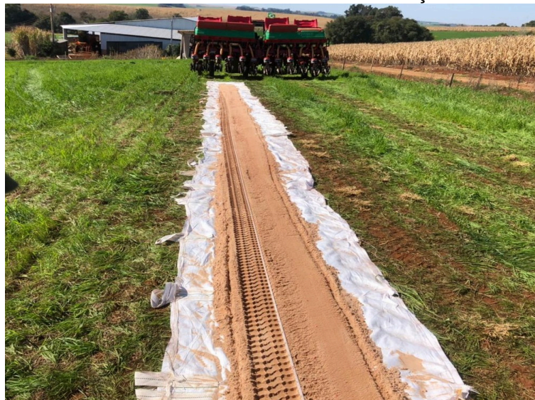
Figura 2 – Caixa de areia utilizada nos ensaios de distribuição de sementes de milho
