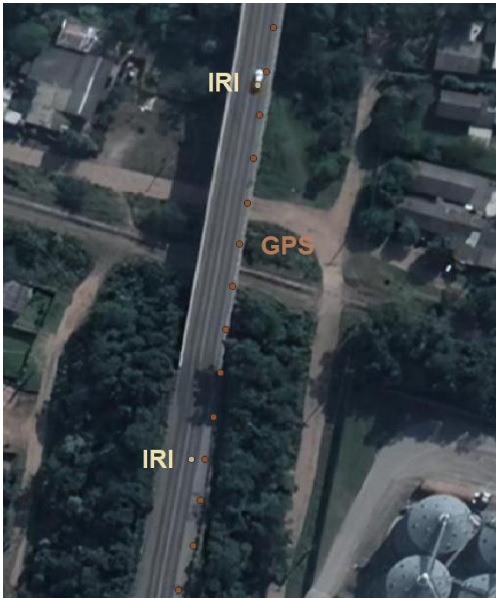
Figura 1: Exemplo da distribuição espacial dos dados dos smartphones e perfilômetro
