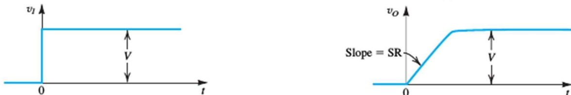
Figura 4: A esquerda um sinal degrau e a direita um sinal com slew-rate .
