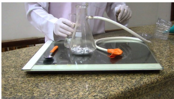
Figura 5 - Sistema Obtenção de Hidrogênio por meio de hidróxidos.
