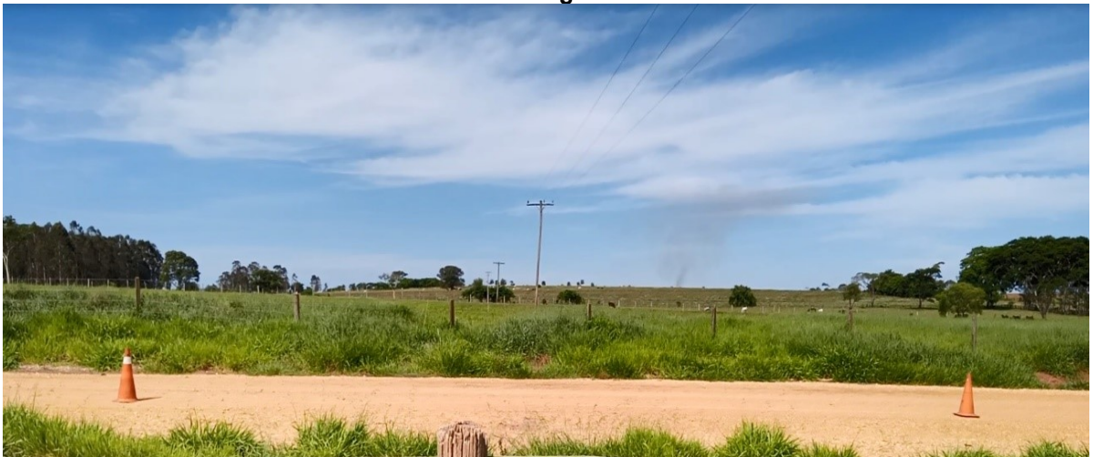
Fotografia 2 - Estrada de terra dura com cascalhos preparada com os cones para os testes de frenagem
