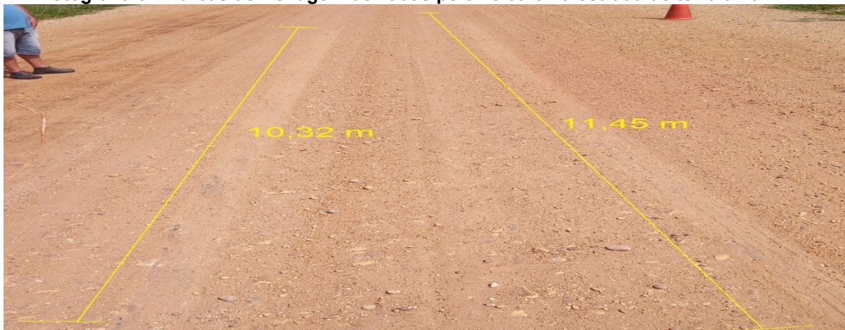
Fotografia 6 - Marcas de frenagem deixadas pelo veículo na estrada de terra a 40 km/h
