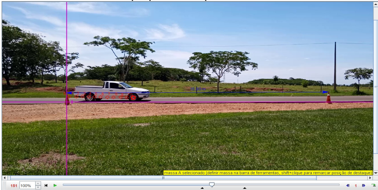
Figura 9 - Fita de calibração (azul) com pouco ou quase nenhum deslocamento devido a efeitos de perspectiva até o quadro de número 151
