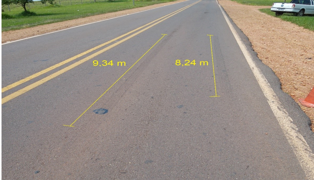
Fotografia 4 - Marcas de frenagem deixadas pelo veículo no asfalto a 40 km/h
