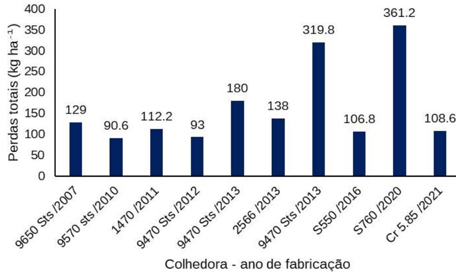
Figura 15 – Perdas totais (kg ha -1 ) na colheita mecanizada de soja de acordo com cada colhedora avaliada. UTFPR, Pato Branco – PR, 2022
