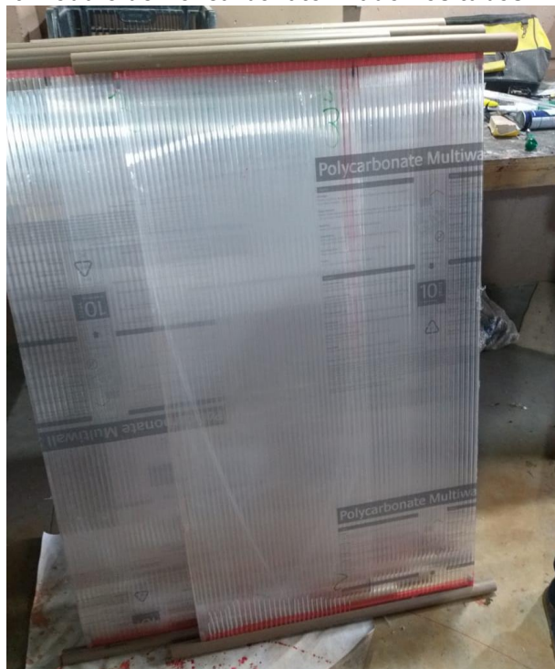
Figura 10 Módulo de Policarbonato fixado nos tubos PVC
