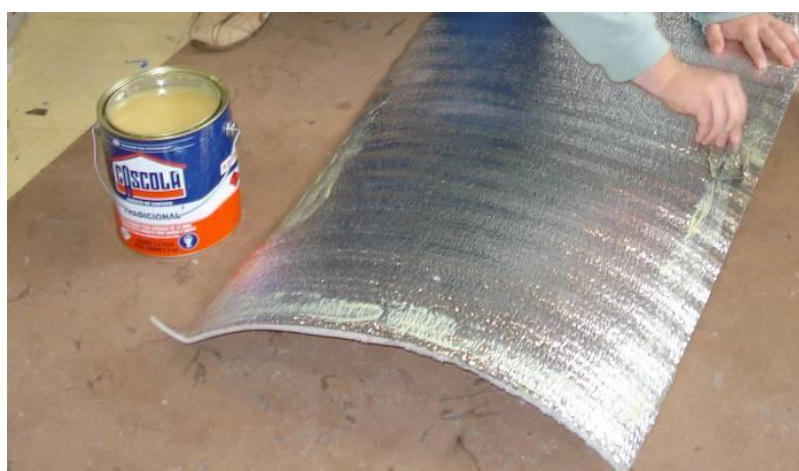
Figura 11 Colagem do isolante térmico na placa de policarbonato
