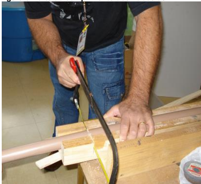
Figura 8 Corte do comprimento dos Tubos de PVC
