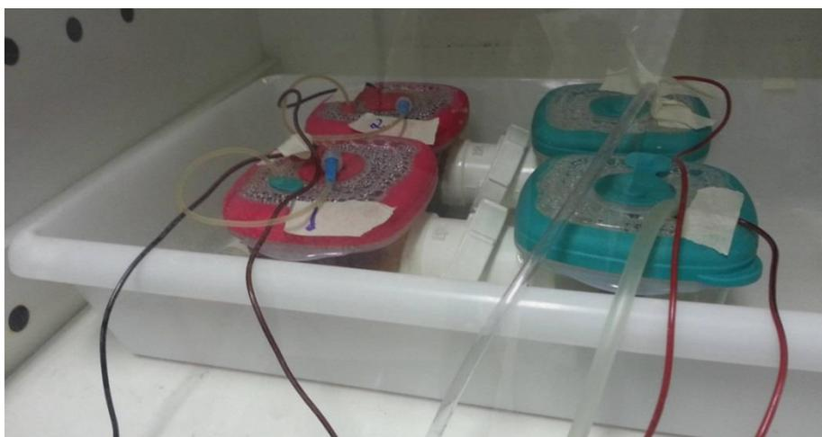
**Figura 14. Foto das duas CCMs construídas em polipropileno e PVC.**
