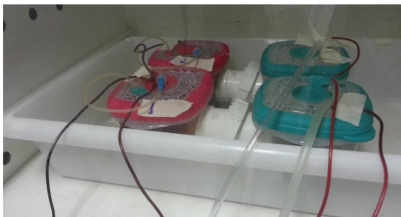
**Figura 34. Experimento com CCM de 300 ml**
