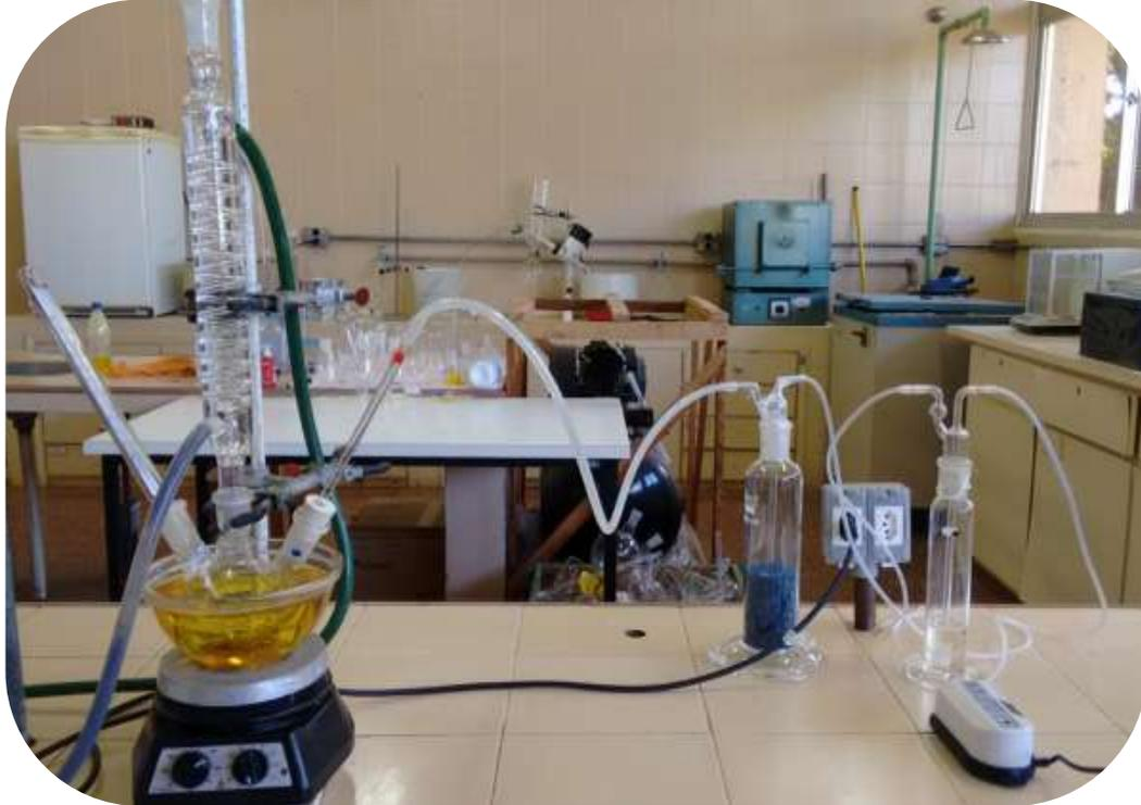
**Figura 22- Esquema do processo de degradação térmica.**
