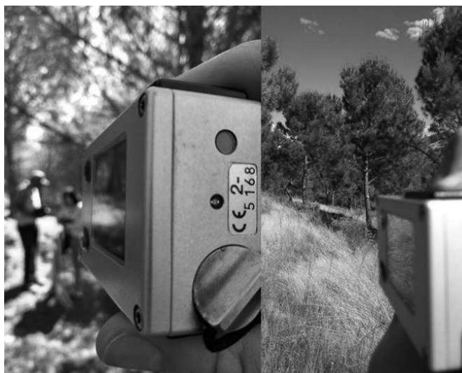
Figura 5: Medição de altura total e altura de copa na área de estudo
