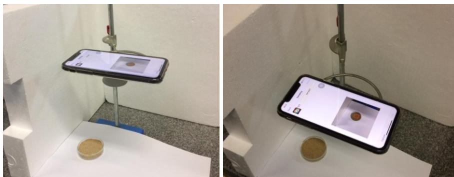
Figura 1. Esquema para aquisição das imagens digitais das farinhas
