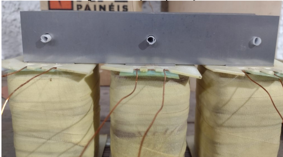
Figura 32 - Isolação da perfuração
