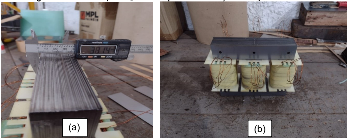
Figura 31 - Núcleo: a) Medição do empilhamento e b) Finalização do fechamento
