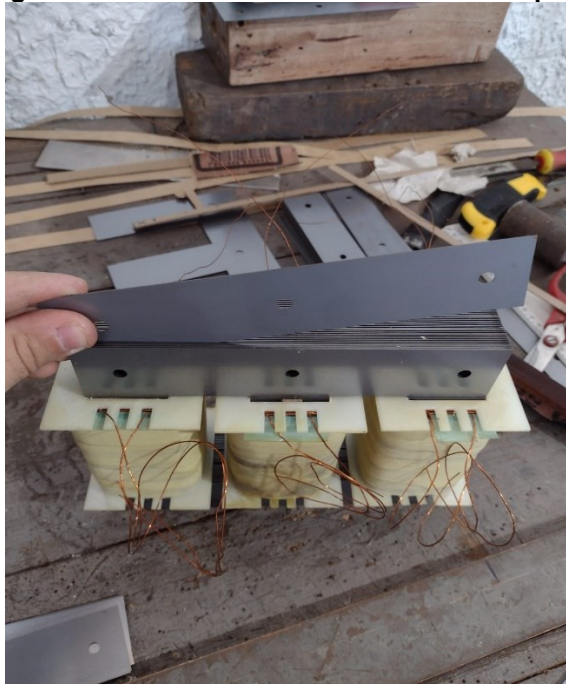
Figura 30 - Fechamento do núcleo com chapas I
