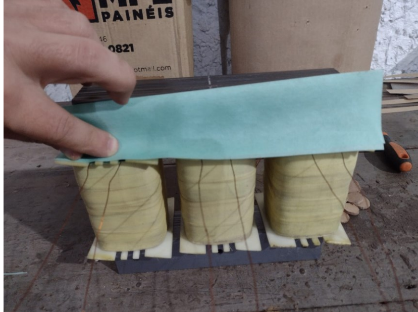
Figura 34 - Papel para isolar as barras galvanizadas
