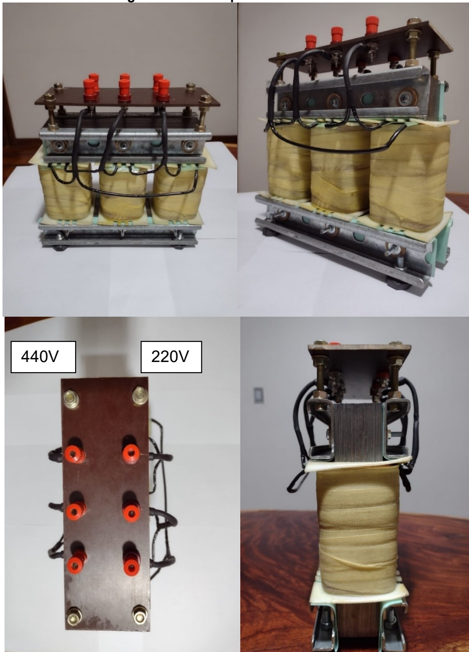
Figura 38 - Protótipo do transformador
