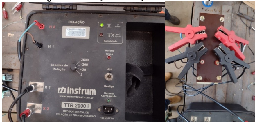
Figura 37 - Medição da relação de transformação
