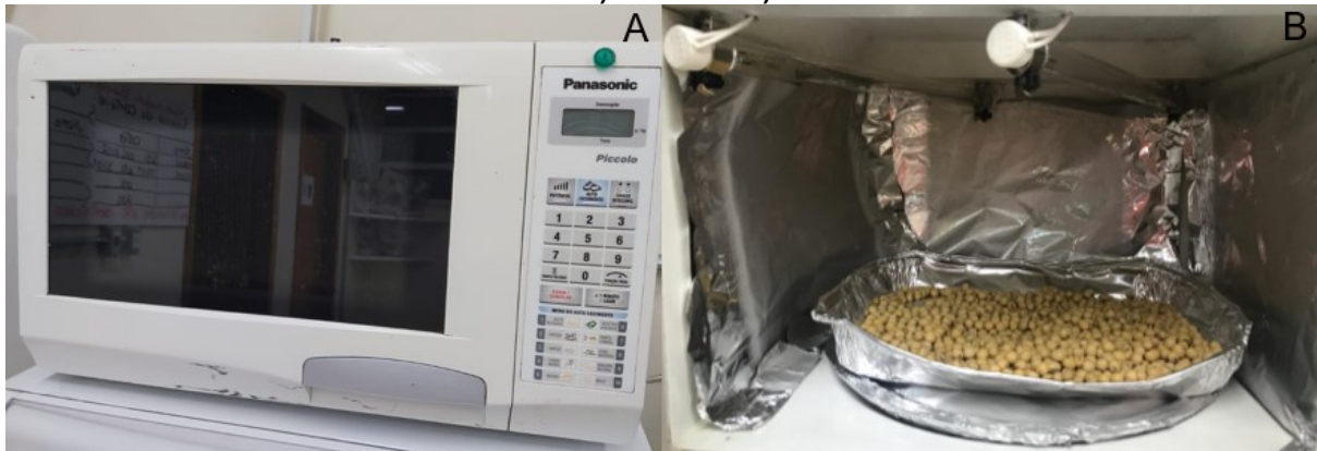
Fotografia 2 - Equipamento microondas adaptado para exposição das sementes de soja com luz UV-C. A) Externo. B) Interno.
