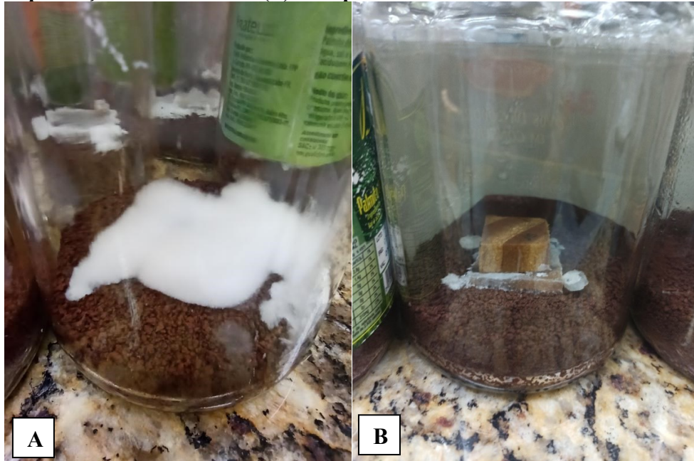
Figura 17 – Imagens do fungo P. placenta (fr.) nas amostras de Pinus ssp. sem nenhum tratamento (A) e com a presença de óleo essencial (B) na superfície da madeira.
