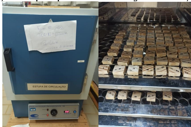
Figura 10: Demonstração dos corpos de provas na estufa de secagem com circulação de ar forçada.
