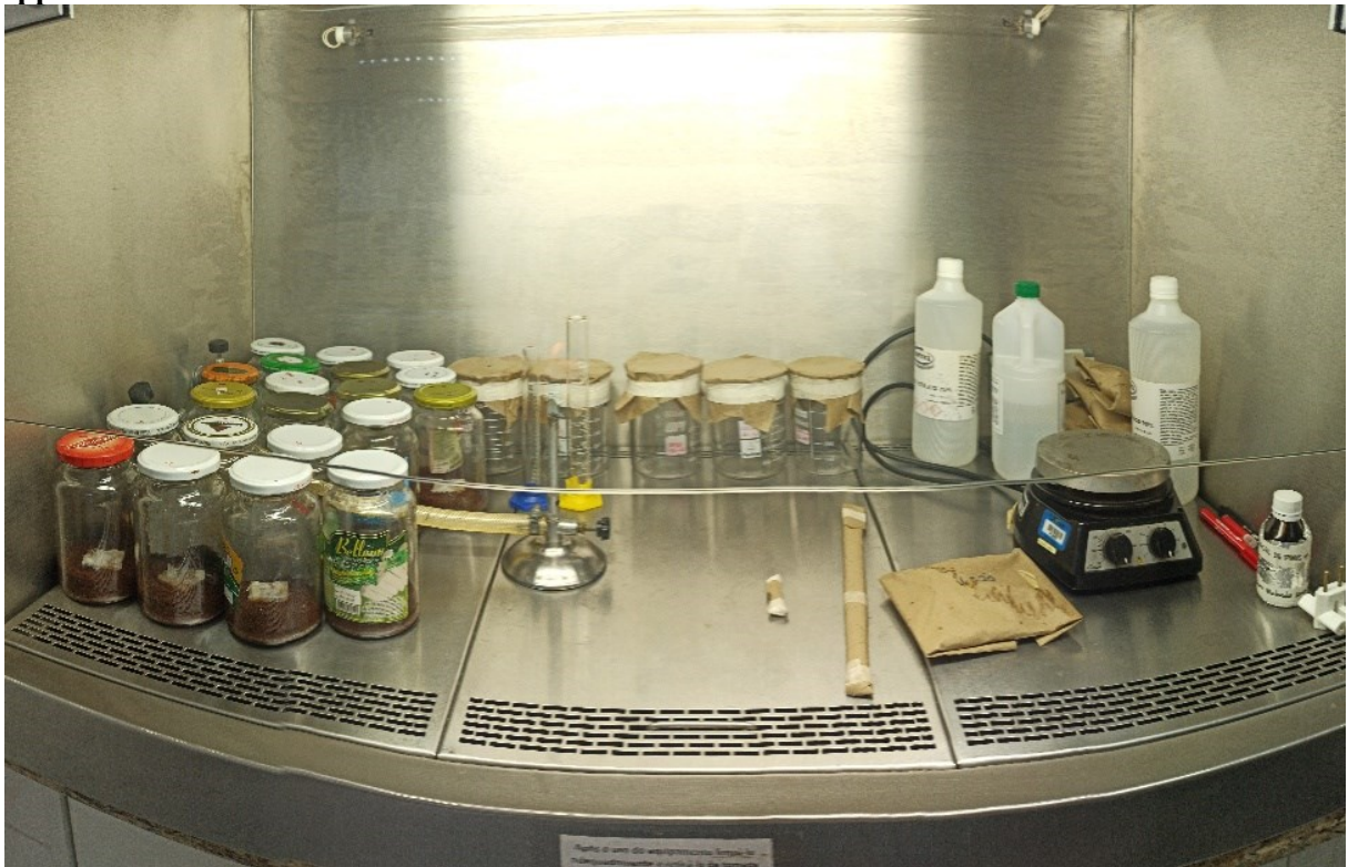
Figura 14: Realização da montagem do experimento, aonde os corpos de provas foram submergidos em cada soluções contendo as concentrações de óleo essenciais das acículas de Pinus spp.
