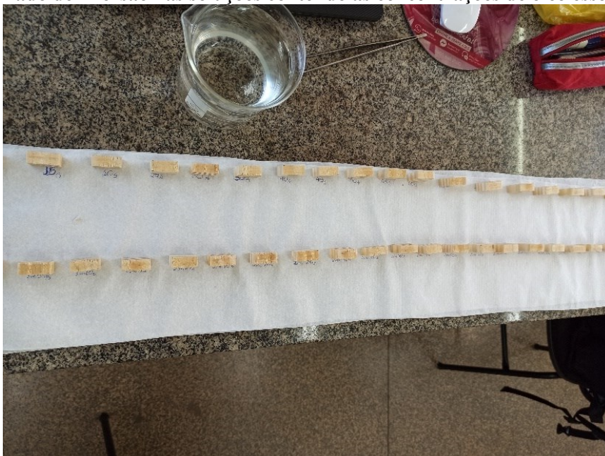
Figura 13: Realização de um teste de absorção dos corpos de provas, com objetivo de obter um tempo aproximado de imersão nas soluções contendo as concentrações de óleo essenciais.
