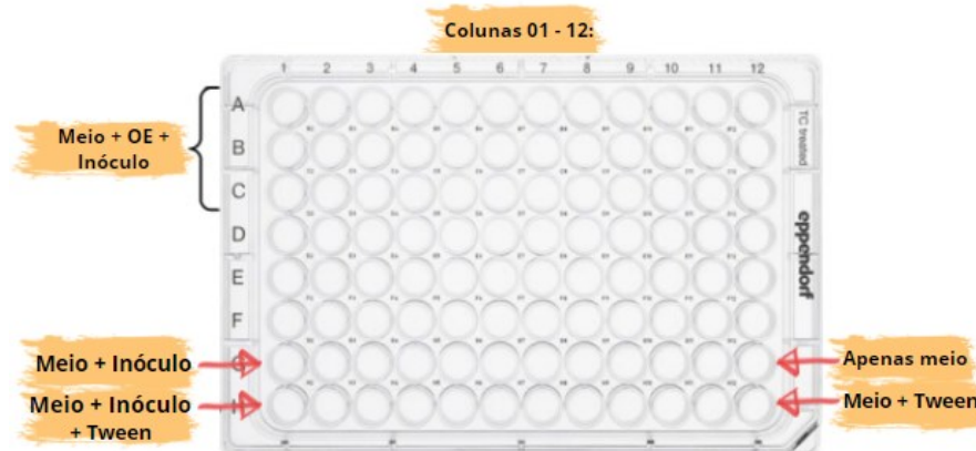
Figura 07: Demonstrativo de como foi posicionado as concentrações contendo as soluções de interesse na Placa de Elisa utilizada, para a determinação da Concentração Inibitória Mínima (CIM).
