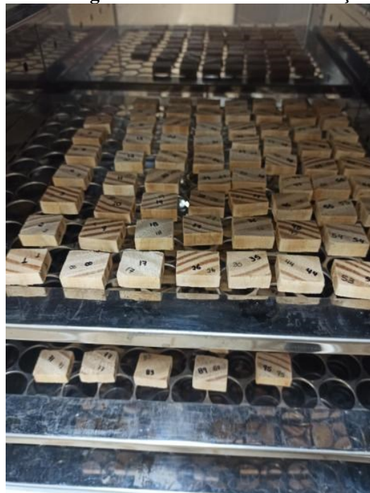
Figura 08: Corpos de prova confeccionadas a partir da madeira de Pinus spp., sendo secados na câmara de secagem climatizada com circulação de ar.
