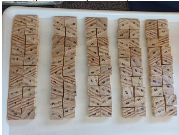
Figura 09: Demonstração dos corpos de provas após serem dimensionados e identificados para serem levados a estufa de secagem com circulação de ar forçada.
