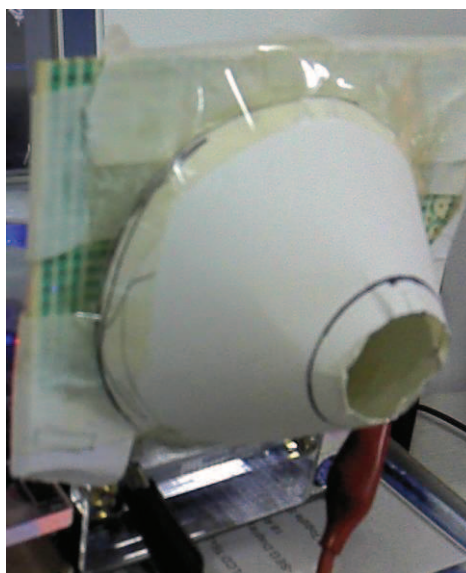
Figura 19 - Cone acoplado à câmera (abrigando LEDs infravermelhos) para propiciar uma iluminação mais uniforme e controlada sobre o olho.
