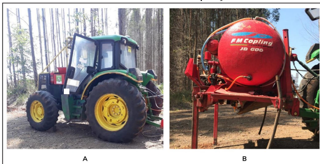
Figura 2 - Trator John Jeere com potência de 100 CV (A) e pulverizador conceição (B) a serem utilizados no método convencional de aplicação de herbicida
