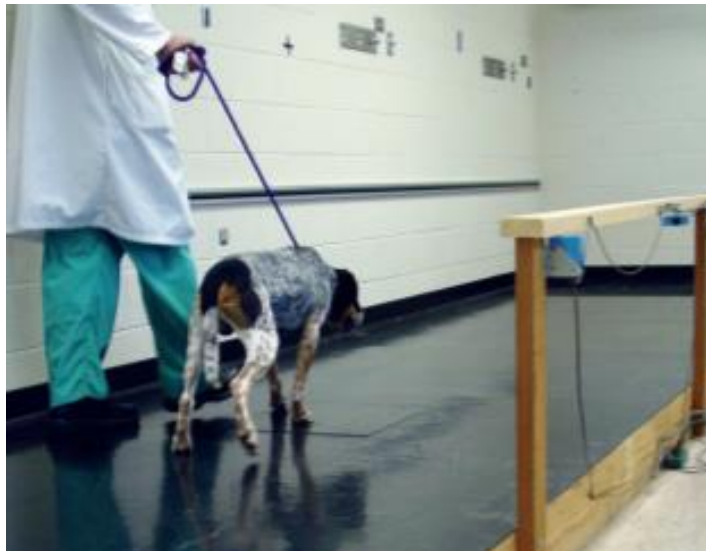
Figura 14: Cão trotando na plataforma de forças.
