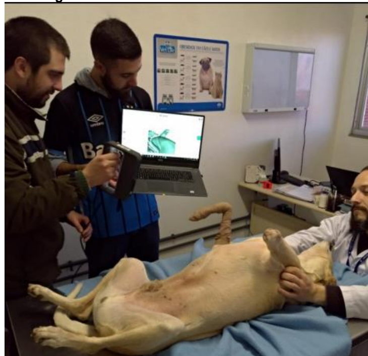
Figura 30: Escaneamento do membro residual.
