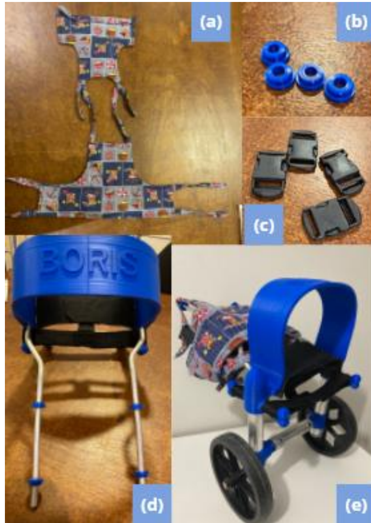
Figura 58: (a) Colete; (b) Travas; (c) Fechos de engate; (d) Hastes com as travas; (e) Prótese finalizada.
