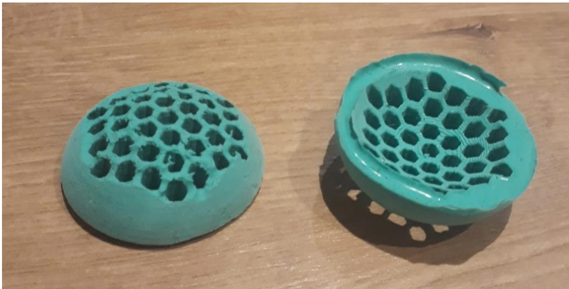
Figura 24: Borracha siliconada verde pronta para ser posta no fundo da capa protetora.
