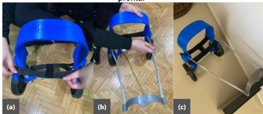
Figura 54: (a) Inserindo a fita de suporte; (b) Inserindo as hastes de sustentação; (c) Prótese pronta.
