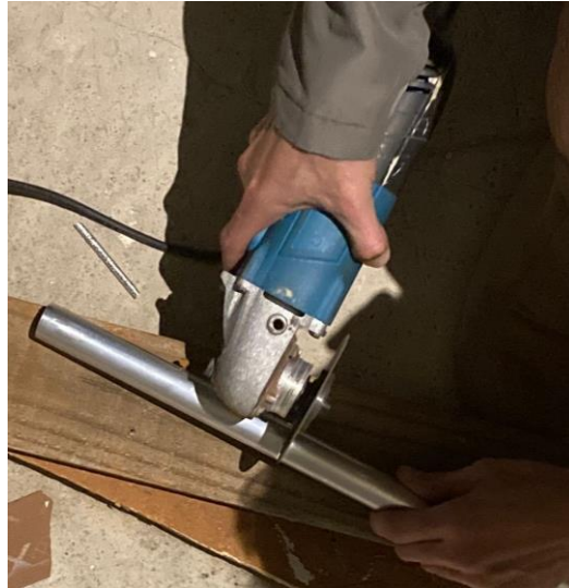
Figura 49: Corte do alumínio para encaixe das peças.
