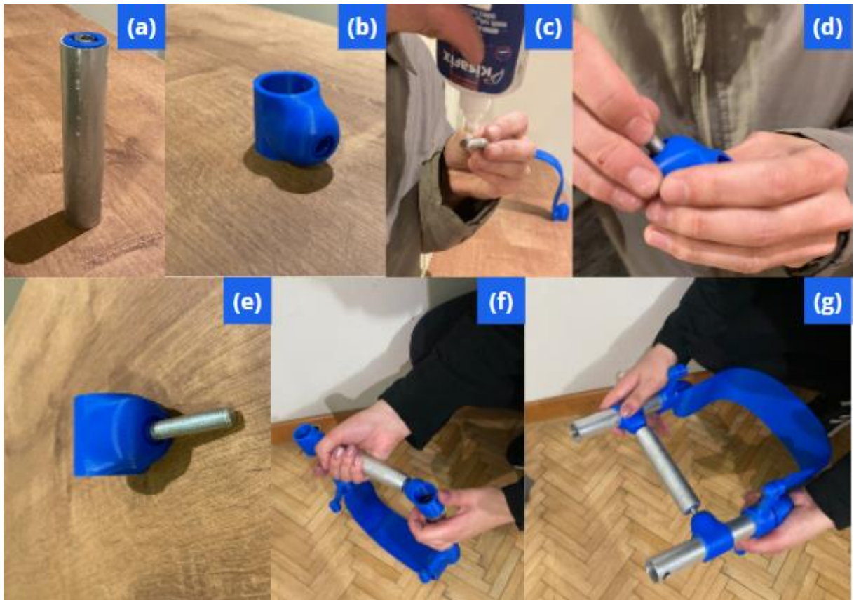
Figura 52: (a) Peça que serve como regulador de distância; (b) Rolamento; (c) Super bonder sendo passado na rosca para acoplamento no rolamento; (d) Rosca sendo acoplada; (e) Rolamento com rosca; (f) e (g) Encaixe das peças na haste de alumínio.
