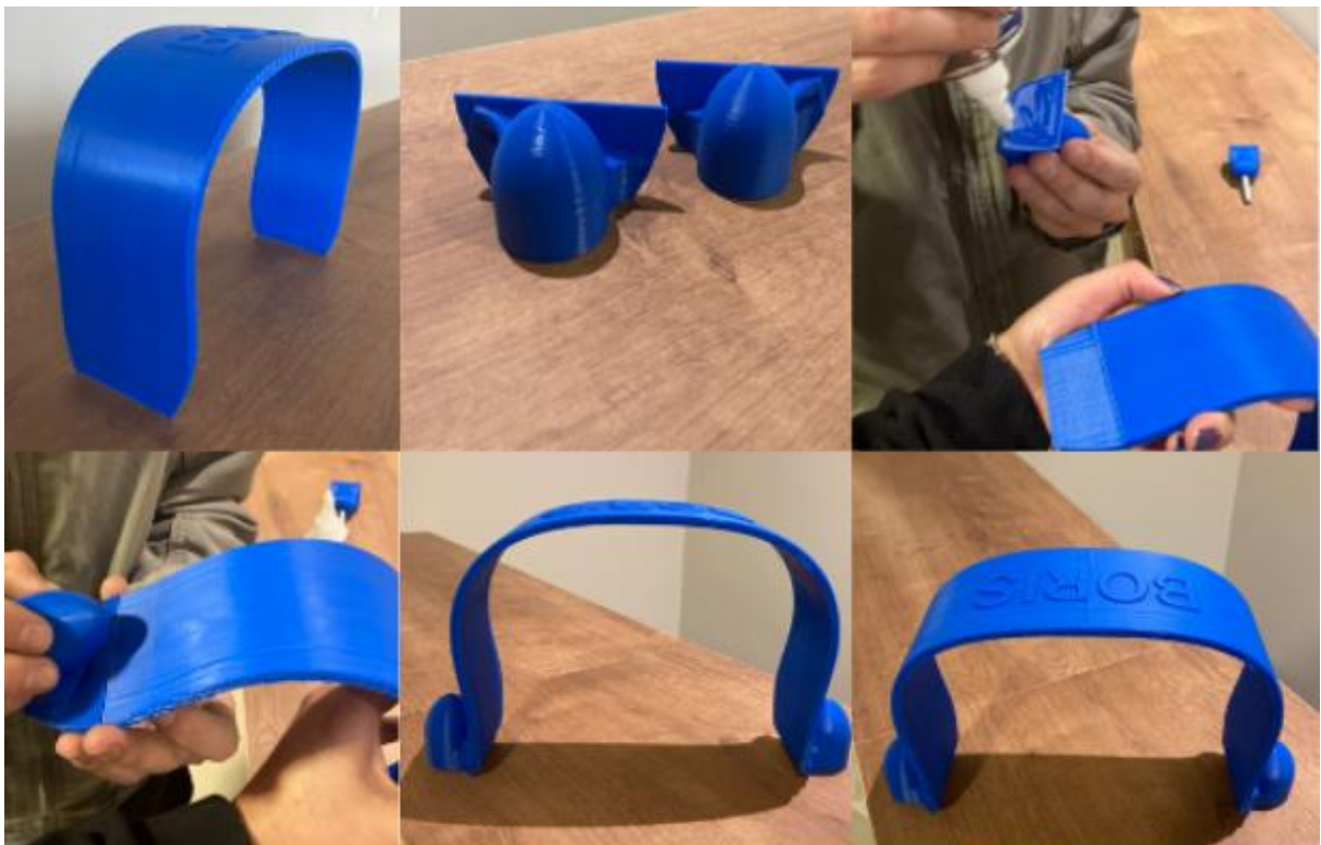
Figura 48: Montagem de primeira peça da prótese.
