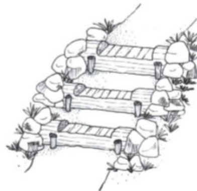
Figura 6- Escada feita de tronco de madeira.
