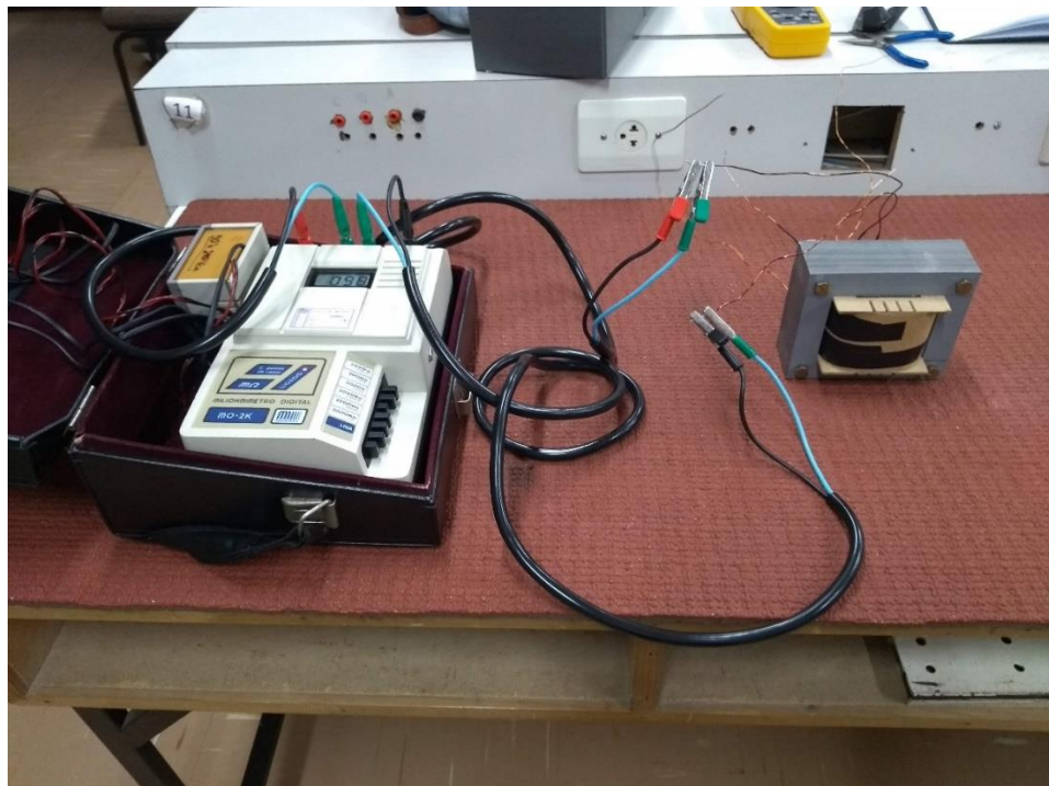
Figura 24: Teste com o miliohmímetro. Fonte: Autoria Própria.
