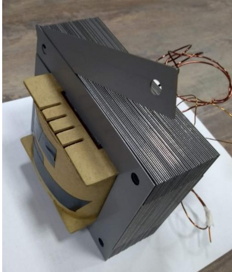
Figura 17: Montagem das lâminas de formato I . Fonte: Autoria própria.
