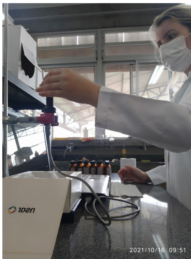
Figura 3 - Ilustração da realização das medidas espectrais NIR
