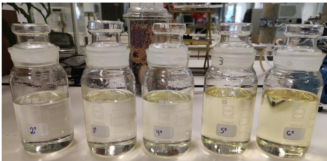
Figura 13 - Frascos com amostras de óleo após teste de envelhecimento.
